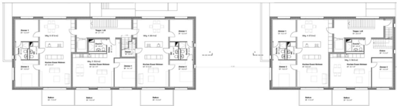
Abbildung 18: Grundriss Obergeschoss mit 3 x 3 Zimmer und 2 x 2 Zimmerwohnung
